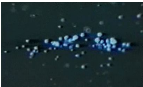
球状星云型空化泡 形成的瞬间（1/1000 秒）
